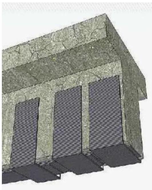
Программа предназначена для проектирования усиления железобетонной балки путем устройства внешнего армирования композитным материалом согласно СП 164.1325800.2014 [1] и СП 63.13330.2018 [2].
