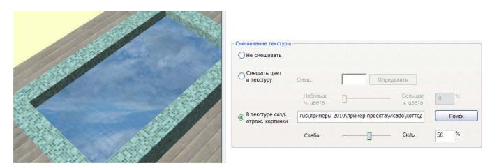
С помощью ползунка-регулятора Вы можете задать степень отражения картинки в текстуре в диапазоне от слабого отражения (0%) до полного отражения (100%).
