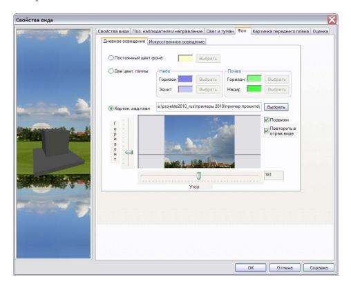
С помощью пункта контекстного меню **Видимость** добавьте сюда предварительно подготовленный земельный участок и позиционируйте модель на созданном фоне, используя колесико мыши и клавиши управления курсором.
