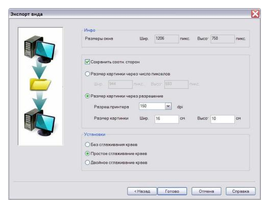
Размер картинки Вы можете легко определить, задав значения в пикселах, или используя параметры принтера.
