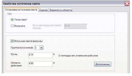
Как видно из диалога свойств, в нашем примере источник света определен как *точечный источник света*.
