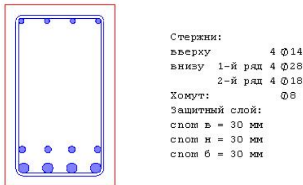
Рис. 6. Пример конструирования арматуры
