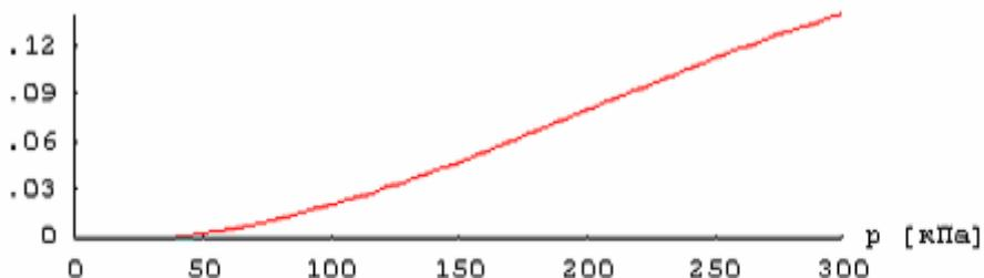
Рис.5. Пример зависимости относительной просадочности от давления
