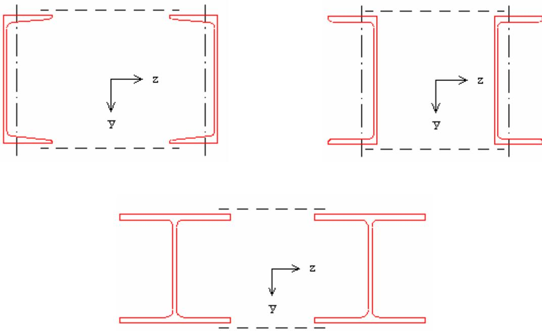
Рис. 5. Сечения сквозной колонны
