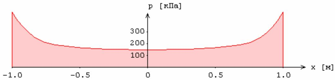
Рис.3. Пример распределения давления под подошвой абсолютно жесткого фундамента
