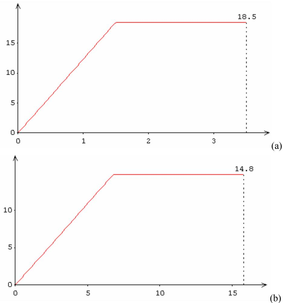
Рис.4. Диаграмма для сжатого бетона согласно СТО НИИЖБ при  $20^{\circ}C$  (а) и  $500^{\circ}C$  (б)
