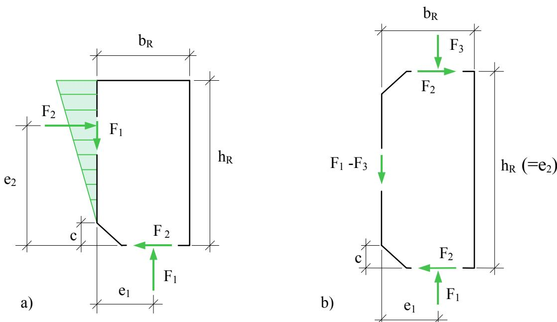
Рис. 5. Нагружение ребра
