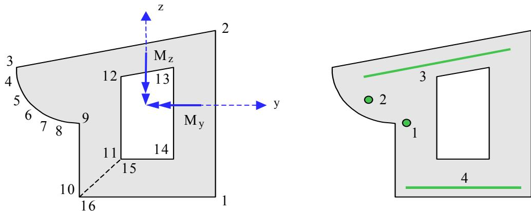
Рис. 3. Произвольное многоугольное сечение
