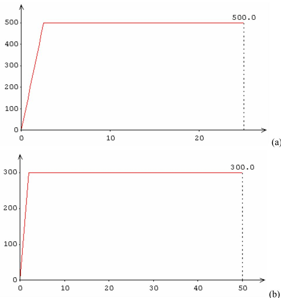
Рис.6. Диаграмма для арматуры согласно СТО НИИЖБ при  $20^{\circ}C$  (а) и  $500^{\circ}C$  (б)
