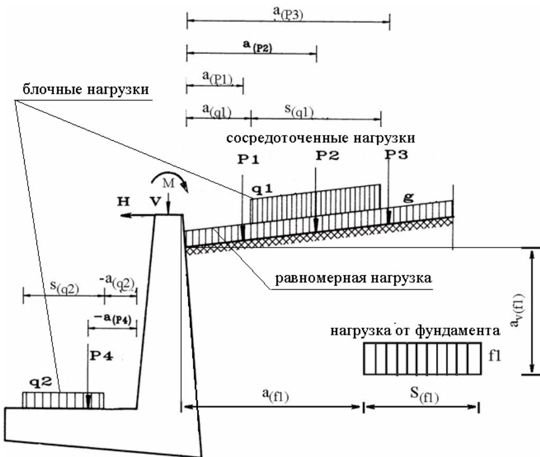
Рисунок 2: Нагрузки
