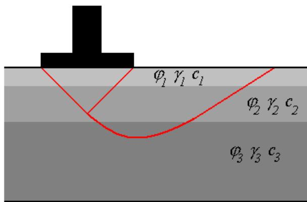
Рис. 4. Область осреднения характеристик грунта
