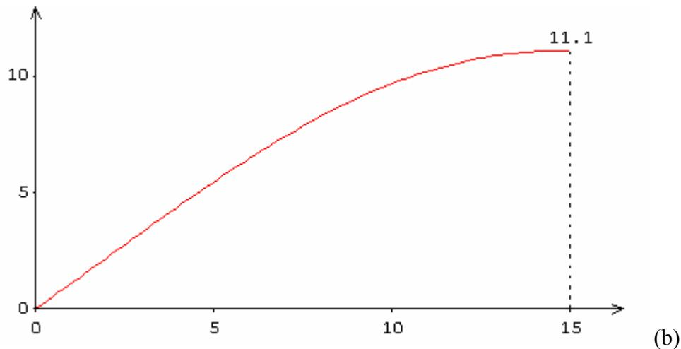
Рис.5. Диаграмма для сжатого бетона согласно Eurocode 2 при  $20^0C$  (а) и  $500^0C$  (б)
