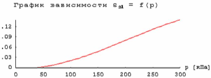
Рис.3. Пример зависимости относительной просадочности от давления
