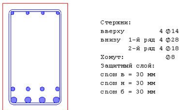
Рис. 6. Пример конструирования арматуры
