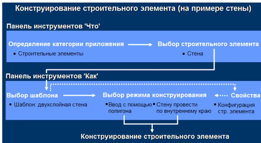
В нашем примере, с помощью панели инструментов 'Как', был выбран шаблон стены **двухслойная стена**. В качестве способа установки было выбрано конструирование с помощью **многоугольника**, линией привязки стены при ее установке определена линия **внутреннего края стены**.
