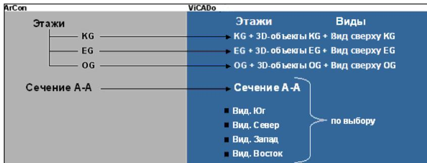
Импорт не является простым переносом данных. Передаваемые 3D-объекты в процессе импорта могут модифицироваться с целью их корректного отображения на плане. Так, например, во время импорта можно определить, какие стены, какой толщины, из какого материала и какой конструкции должны изображаться в ViCAdo.
