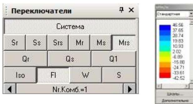
**Iso** – отображение напряжений в виде изолиний.
