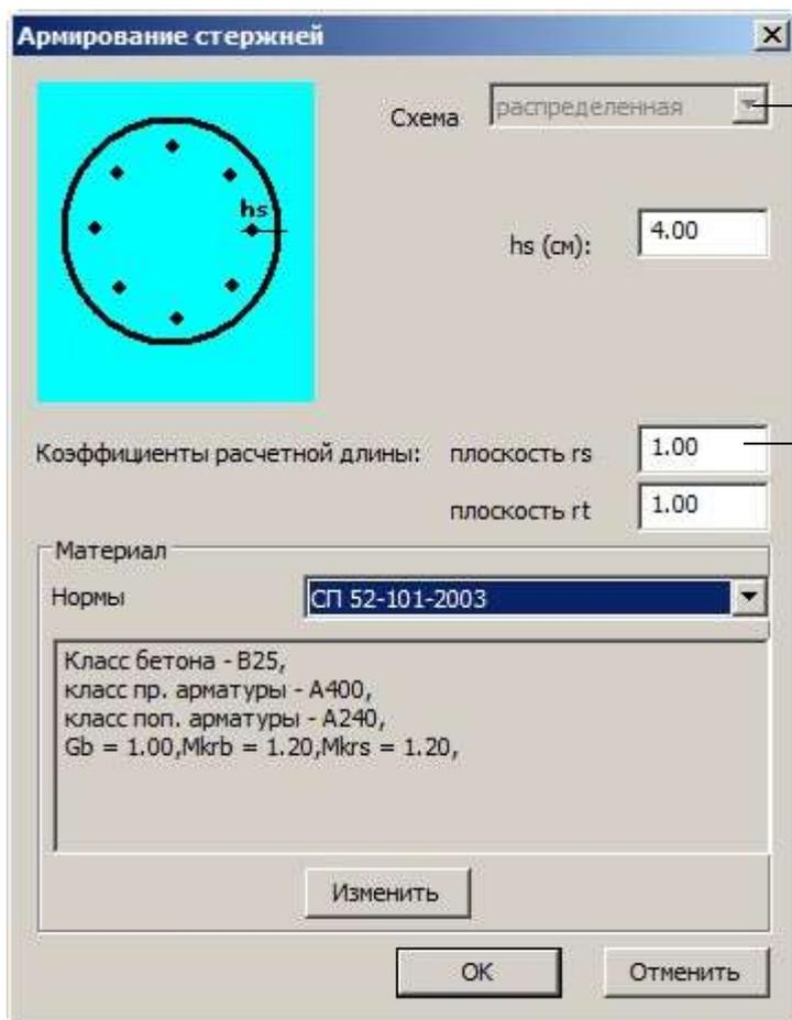
В случае прямоугольного сечения колонны Вам будет предложено три схемы армирования: сосредоточенная, распределенная равномерная и распределенная с разной арматурой в двух направлениях  $r$  и  $s$ .
